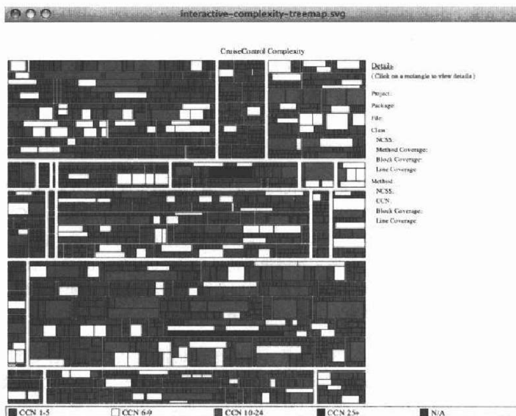
图 7-3：用 Panopticode 给 CruiseControl 项目生成的圈复杂度图
